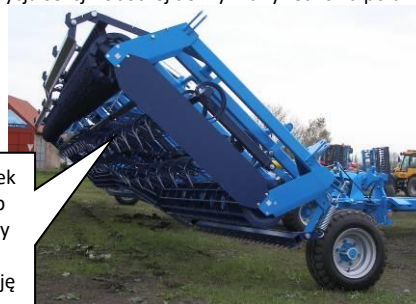
rys.31- pozycja sekcji roboczej do wymiany redlic na polu
