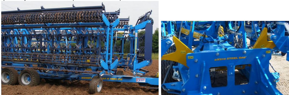
rys.16-sekcja robocza doszła na zapadki umieszczone na podwoziu
