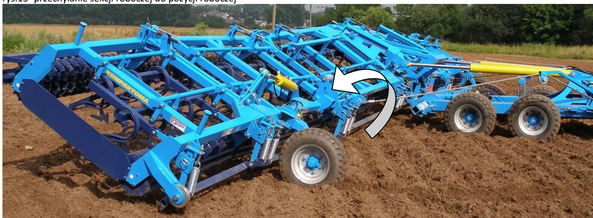
rys.13- przechylenie sekcji roboczej do pozycji roboczej
