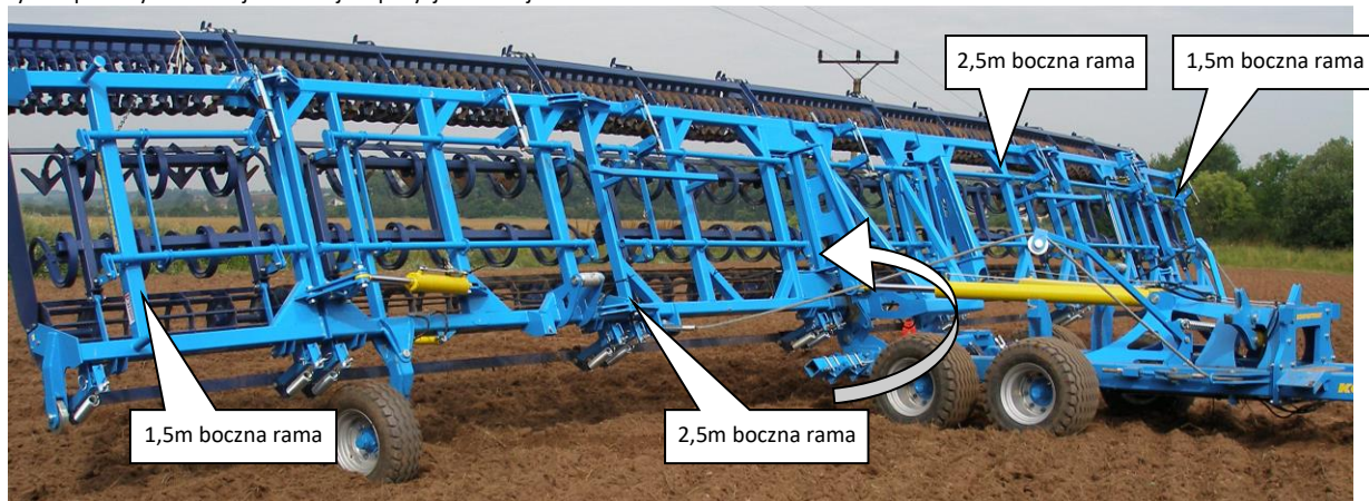
rys.13- przechylenie sekcji roboczej do pozycji roboczej
