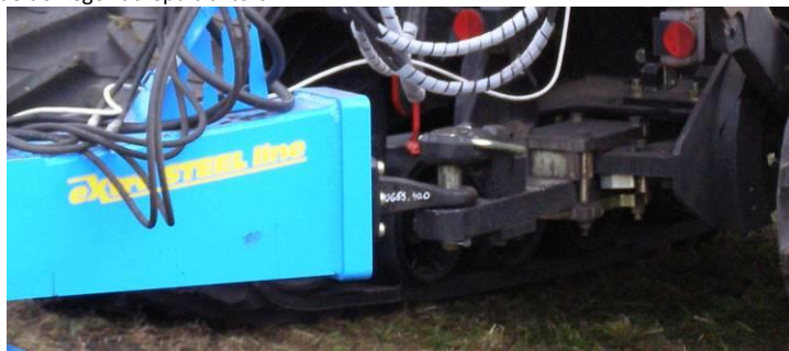
rys.5-podłączenie maszyny do dolnego zaczepu traktora
