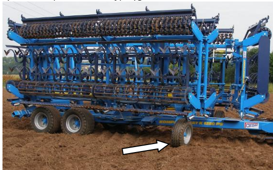
rys.10-koła pomocnicze są przygotowane do rozkładania maszyny
