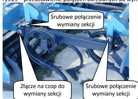
rys.29 – przedstawienie połączeń określonych do wymiany sekcji lemieszki
