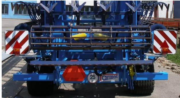
rys.18-umieszczenie tylnych osłon bezpieczeństwa
