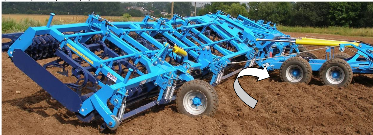
rys.15-zamykanie sekcji roboczych do pozycji transportowej
