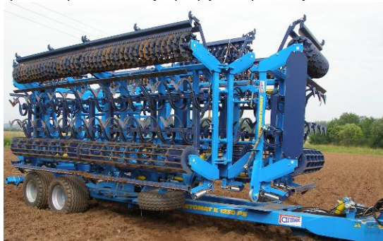
rys.9-koła pomocnicze są w pozycji transportowej
