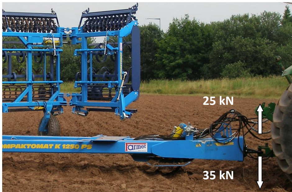
rys.6-przedstawienie obciążenia dolnego zaczepu traktora przy składaniu i rozkładaniu maszyny
