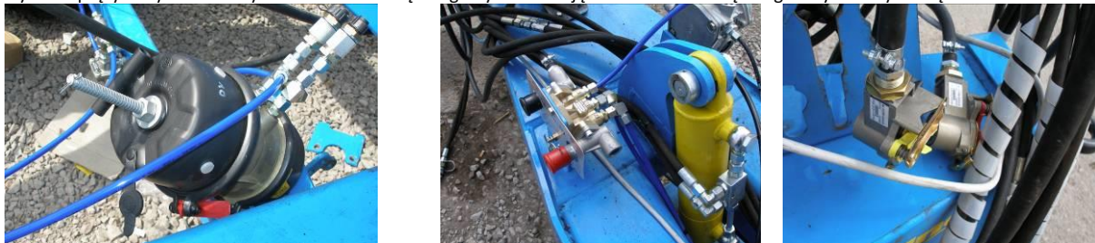
rys.28-detali opisu sterowania zaworów hamulców
