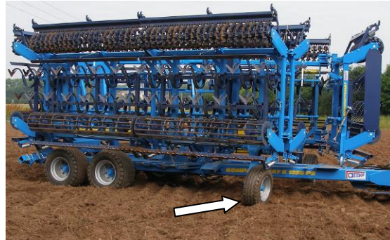
Obr.10-pomocná kola jsou připravena pro rozklápění stroje
