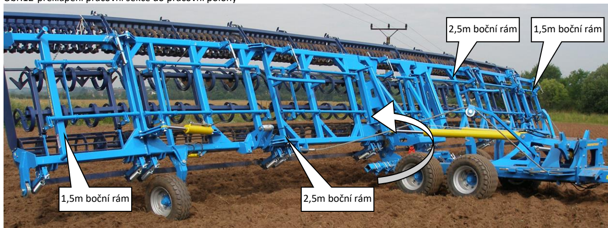
Obr.13-překlápění pracovní sekce do pracovní polohy
