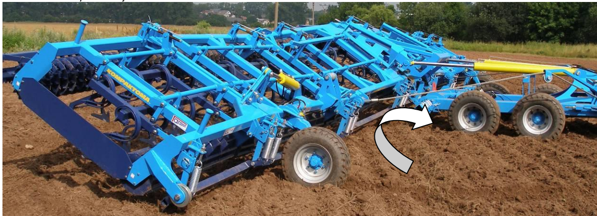
Obr.14-boční rámy se zvedají od země
