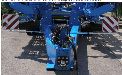
Obr.17-umístění předních bezpečnostních štítů
