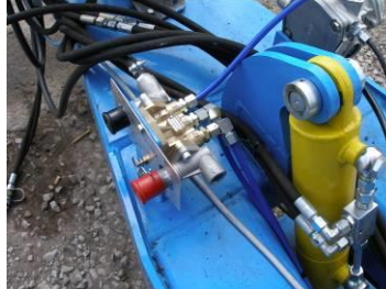
obr.26-ovládací ventil ruční brzdy
