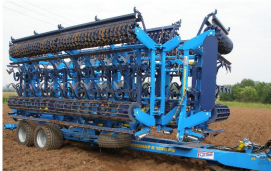
Obr.9-pomocná kola jsou v transportní poloze
