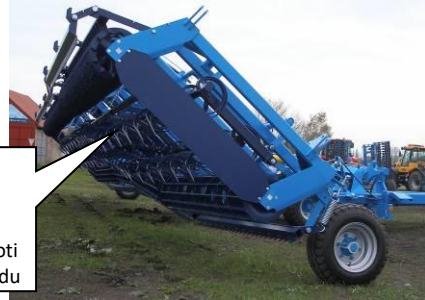
obr.31-poloha pracovní sekce pro výměnu radlic na poli
