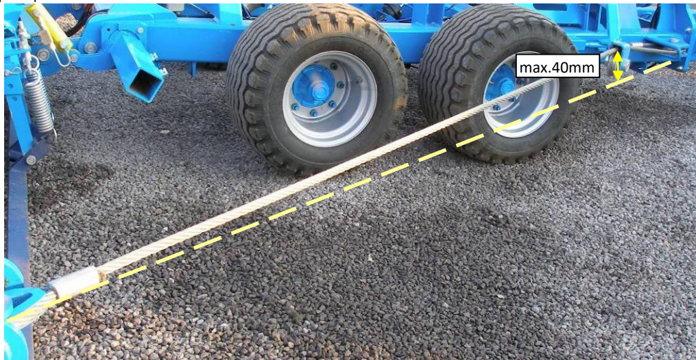
Obr.24-předepnutí tažného lana
