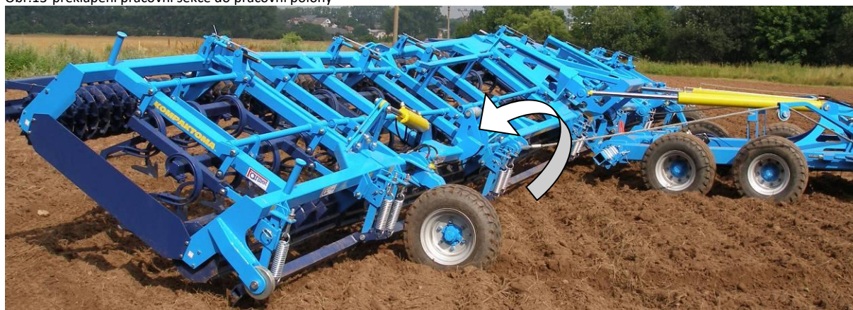
Obr.13-překlápění pracovní sekce do pracovní polohy
