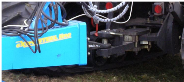
Obr.5-připojení stroje do spodního závěsu traktoru
