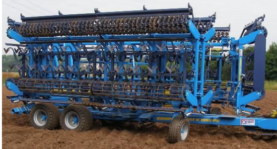
obr.30- stroj v transportní poloze pro výměnu radliček
