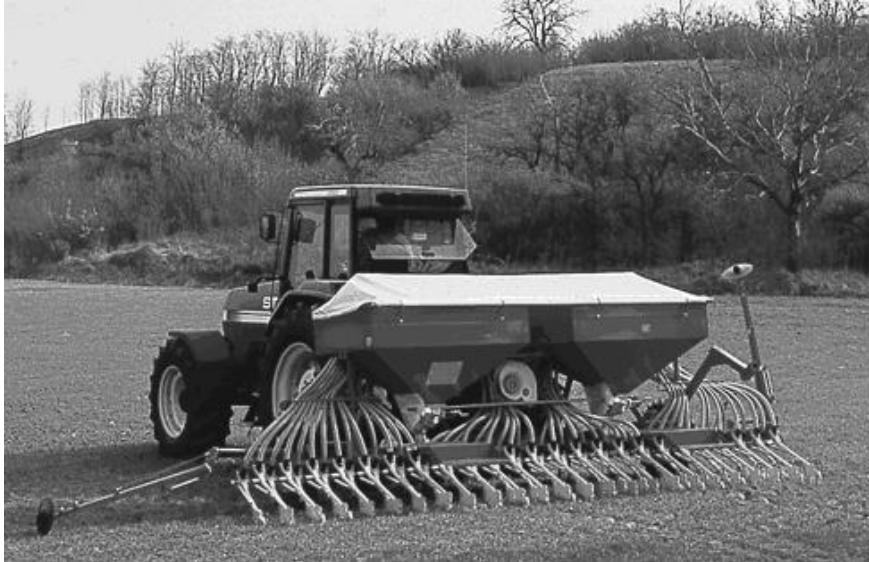
Obr. 13 secí stroj MD s pracovní šířkou 6 m
