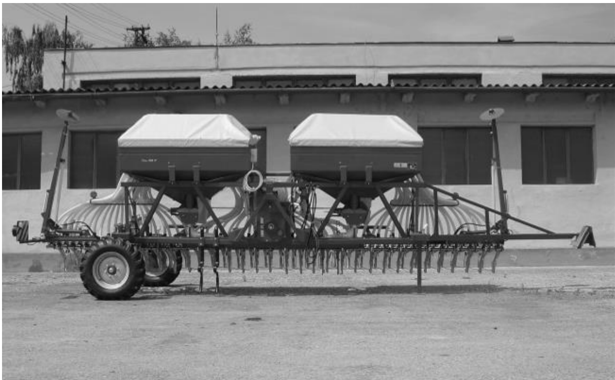
Obr. 15 odstavení secího stroje 6 MT
