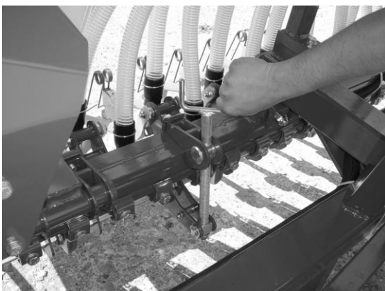
Obr. 3 centrální nastavení přitlaku na výsevní botky
