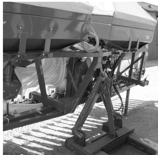
2. Stroj připojit do pracovní polohy a zdvihnout
