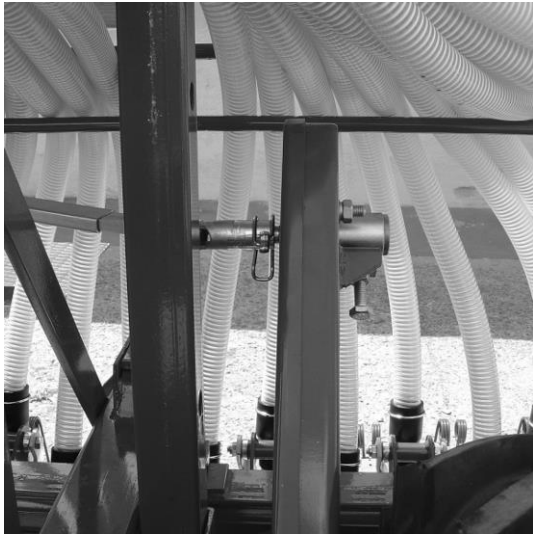
7. Nasadit hnací hřídel a zajistit pružinovou spojkou
