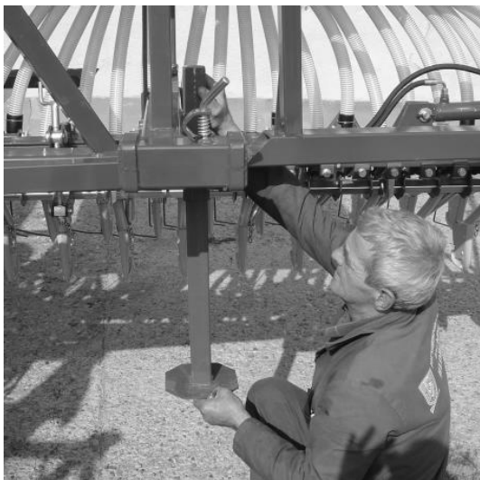
1. Spustit pomocnou nohu a stroj odpojit
