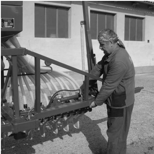
3. Odjistit oj a vytáhnout
