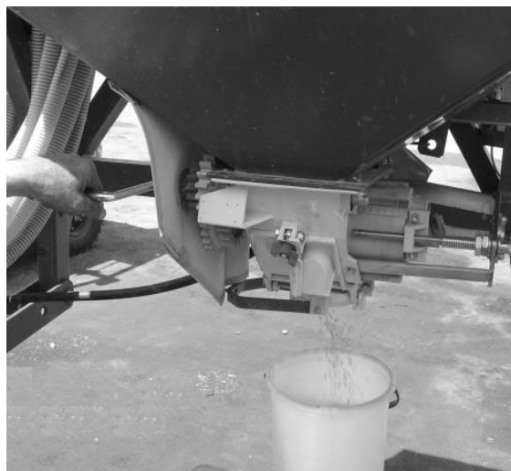
Obr. 7 kalibrování secího stroje
