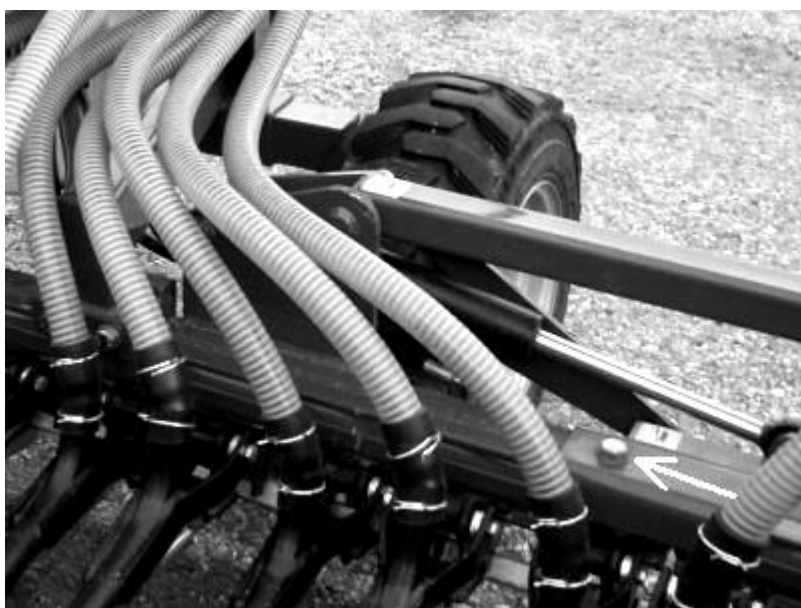
Obr. 12b Zajištění sklopných částí v pracovní poloze
