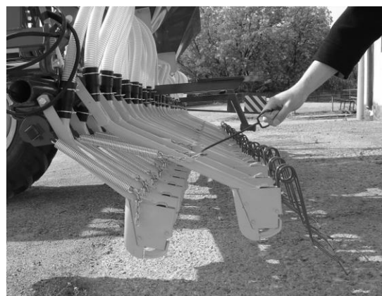
Obr. 4 individuální změna přitlaku na výsevní botku
