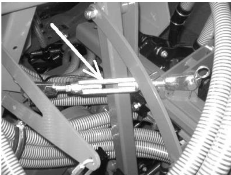
Obr. 12a Zajištění sklopných částí v přepravní poloze
