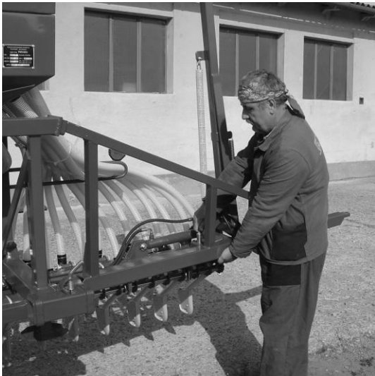
3. Odjistit oj a vytáhnout
