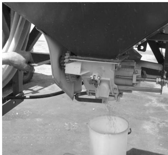
Obr. 7 kalibrování secího stroje
