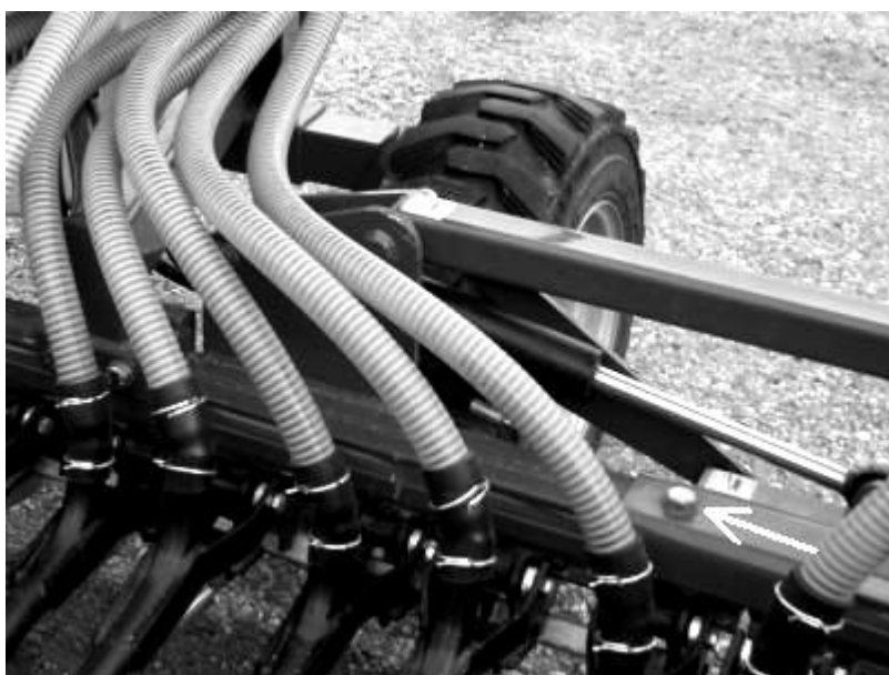
Obr. 12b Zajištění sklopných částí v pracovní poloze
