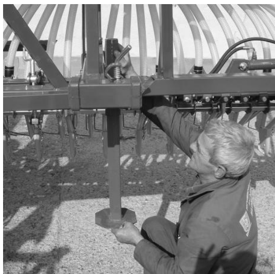
1. Spustit pomocnou nohu a stroj odpojit
