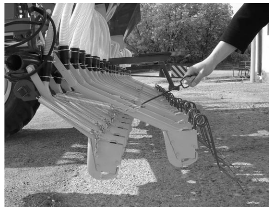
Obr. 4 individuální změna přitlaku na výsevní botku
