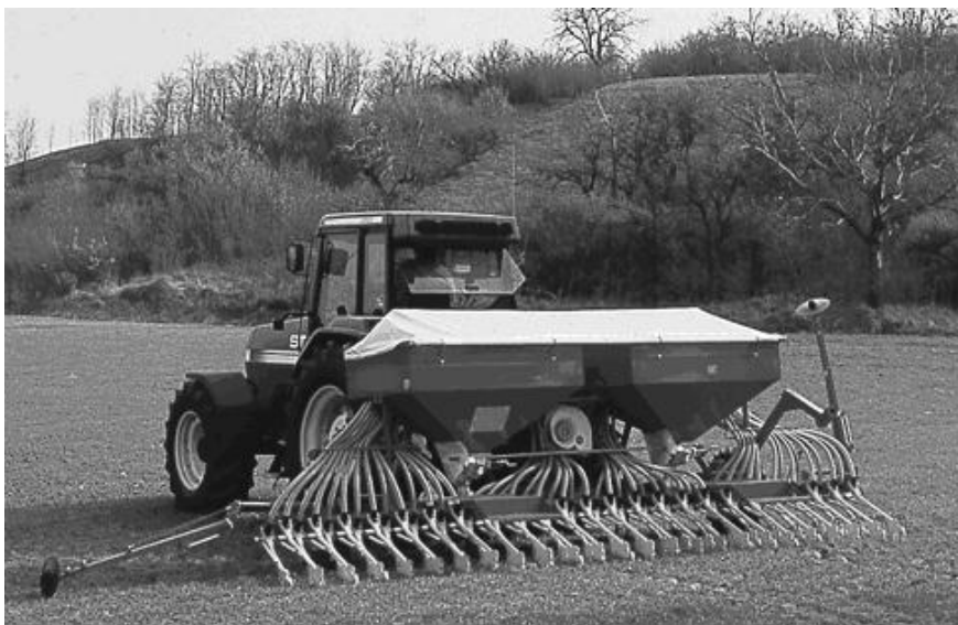
Obr. 13 secí stroj MD s pracovní šířkou 6 m
