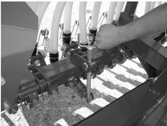
Obr. 3 centrální nastavení přitlaku na výsevní botky
