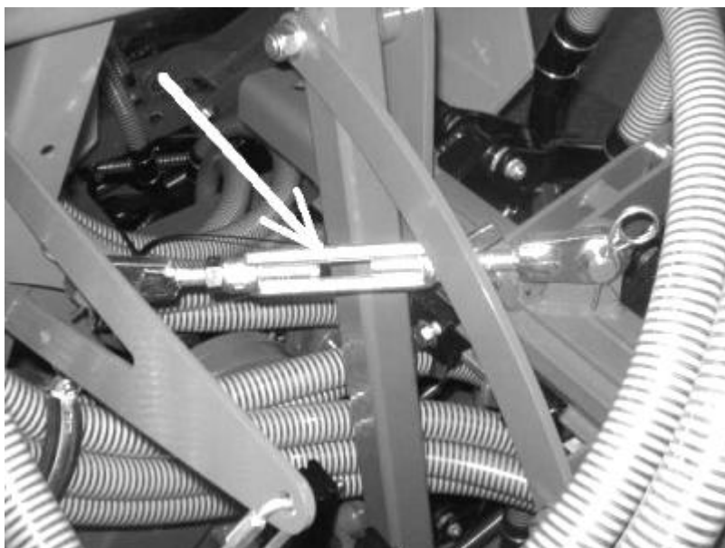
Obr. 12a Zajištění sklopných částí v přepravní poloze
