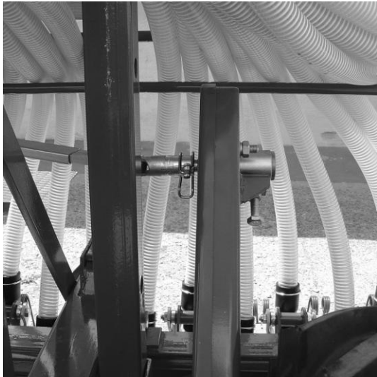
7. Nasadit hnací hřídel a zajistit pružinovou spojkou
