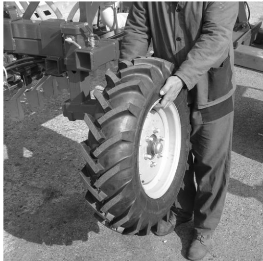
4. Odjistit pravé kolo, vytáhnout, otočit o 90°, Zasunout do otvoru výše a zajistit
