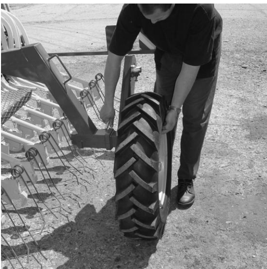
1. Odjistit levé kolo s náhonem, vytáhnout, Přesunout kolo na stranu oje
