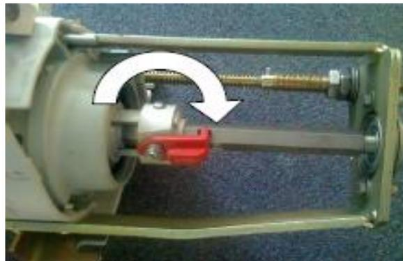
Abb. 33 – Einstellung des Zellenrads des Dosierers
