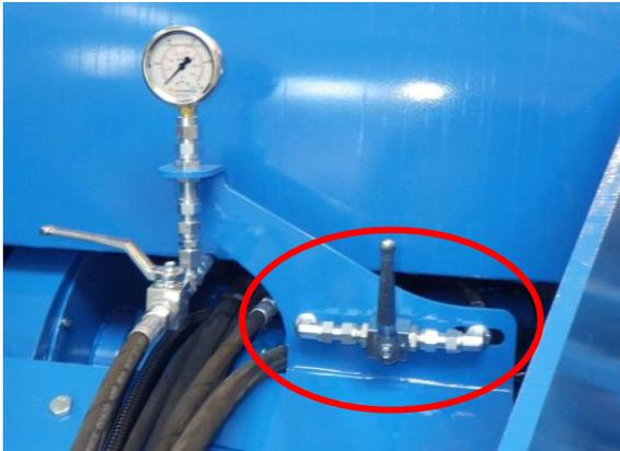
Abb.31- Kugelventil der vorderen Sektion Lage **GEÖFFNET**
