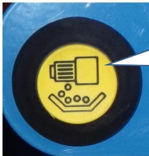
Durch Drücken dieser Taste wird der Beutel mit Saatgut gefüllt (so lange halten, bis im Beutel eine wiegbare Menge ist)
