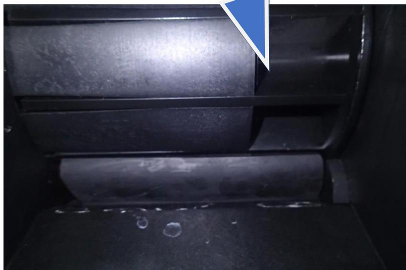
Wir empfehlen nach der Entleerung des Vorratsbehälters einige Meter mit der Sämaschine im Leer, mit laufendem Ventilator "zu säen", um den Saatgutrest aus dem Dosierer sowie aus dem ganzen System der Sämaschine zu entfernen.
