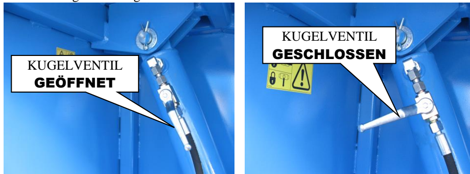
Abb. Stellungen des Kugelventils:
