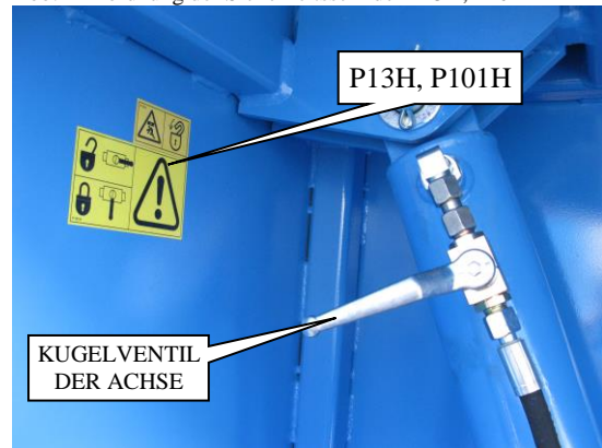
Abb.2-Anordnung der Sicherheitsschilder P13H, P101
