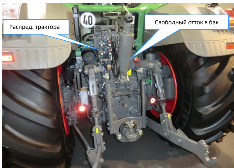
Рис. 6 – размещение штуцеров на тракторе
