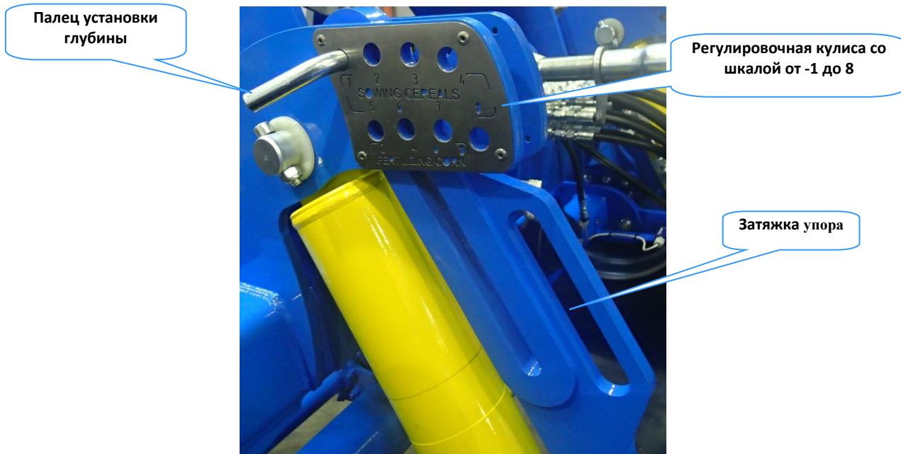
Рис. 42 – Регулировочная кулиса для установки глубины
