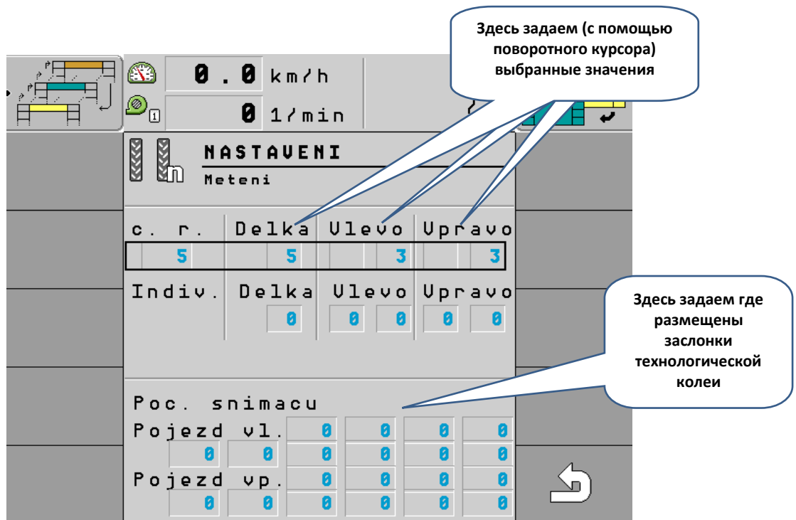
Рис. 19 – Установка ритма технологической колеи на блоке отображения
