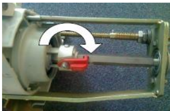
Рис. 33 – Настройка турникета дозатора
