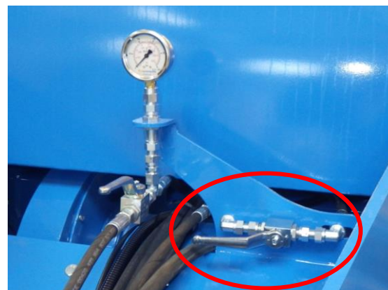
Рис.31- шаровой клапан передней секции поз. ОТКРЫТО
