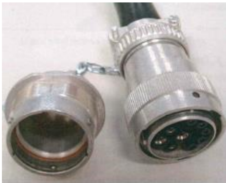
рис. 4 - розетка подключения на дышло машины
