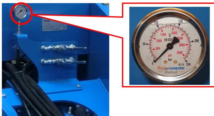
Рис. 45 – размещение манометра давления на рабочих органах сеялки
