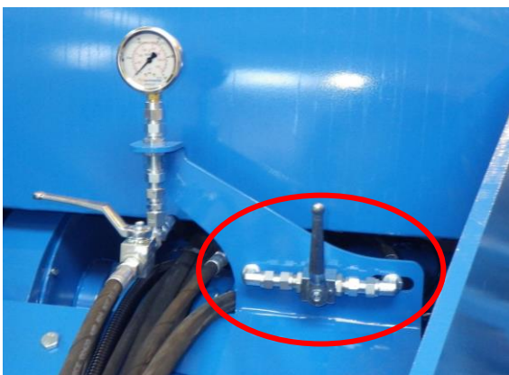
Рис.30 - шаровой клапан передней секции поз. ЗАКРЫТО
